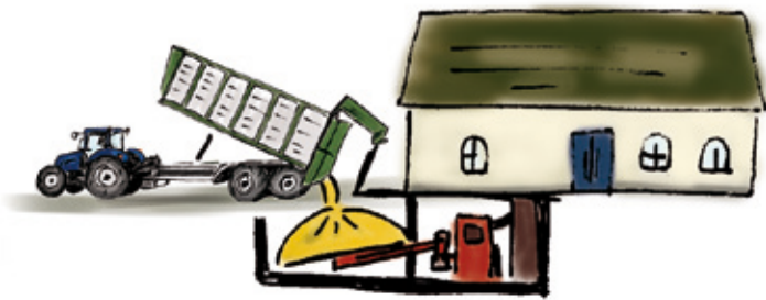
Objektwärmeversorgung mittels Biomasse-Contracting
