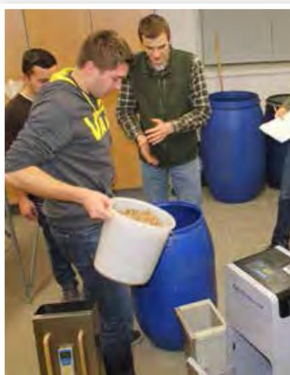
Mit neu entwickelten Geräten lässt sich der Wassergehalt von Proben rasch bestimmen.
