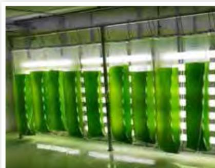
Schlauch-Photobioreaktoren zur Produktion von Mikroorganismen
