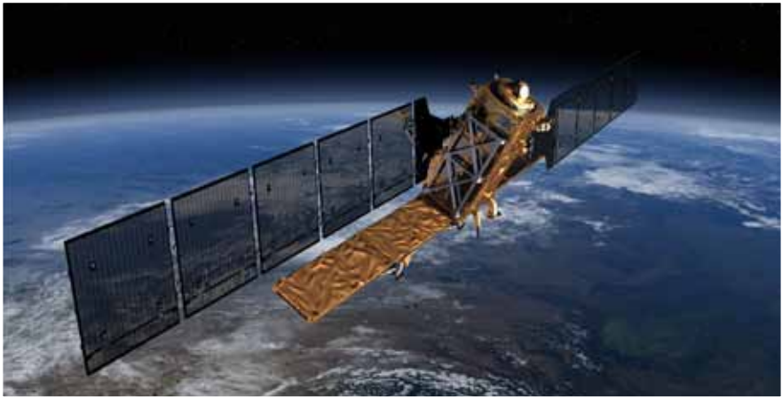
Der Satellit Sentinel-1 misst Windgeschwindigkeit, Meereseis, Eisdecken, Gletscher und Bodenfeuchte.
