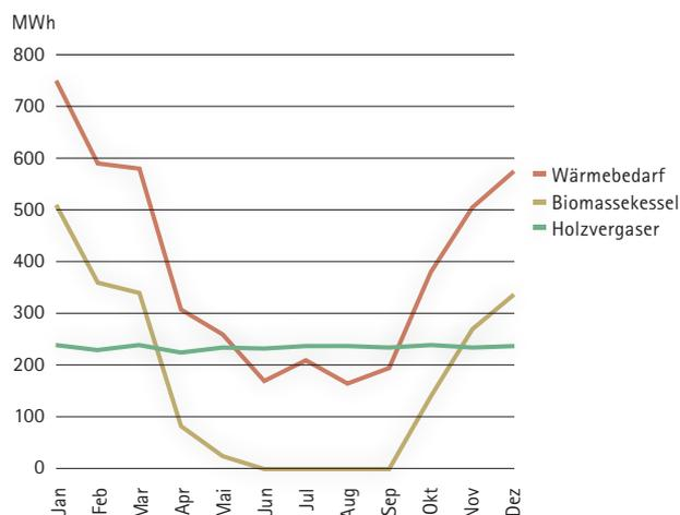
Quelle: Beispielrechnung anhand eines Nahwärmanetzes mit einem Jahres-Wärmebedarf von 5.000 MWh und ganzjährigem Wärmebedarf, Biomasseverband ÖÖ
