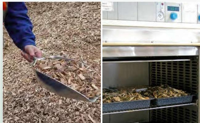
Zur Bestimmung des Wassergehaltes wird das Hackgut nach der Probenahme gewogen und anschließend im Darrschrank getrocknet.
