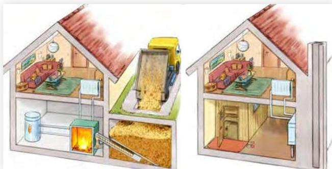
Hackschnitzelheizung mit Lagerraum und Rührwerkaustragung (li.), bei Platzmangel bietet sich der Anschluss ans Nahwärmenetz an (re.).
